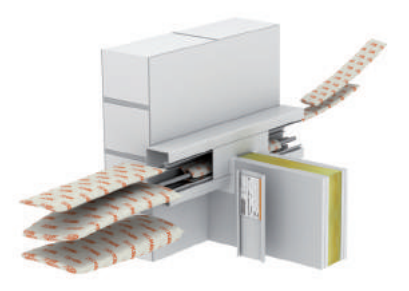
Installazione dei sacchetti nel canale plastico
