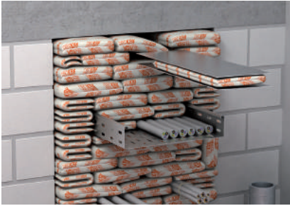
Esempio di posa dell'ultimo strato di sacchetti con l'ausilio di piastre metalliche rigide
