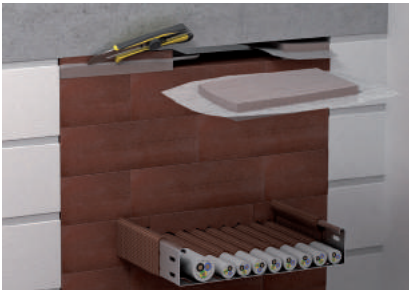
Mattoncini sottovuoto per una facile chiusura degli spazi stretti
