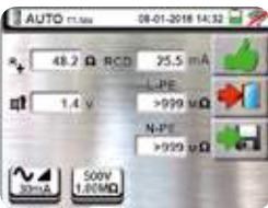
Autosequenza: sequenza automatica delle misure di Resistenza globale di terra, test RCD e Isolamento L-PE, N-PE.
