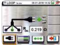
Zero Loop: compensazione resistenza dei cavi di prova nella misura di Impedenza di Loop.
