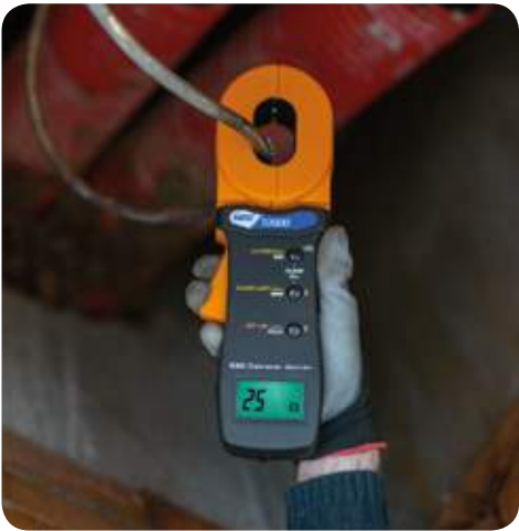
Misura della resistenza di Terra con Pinza T2100.
