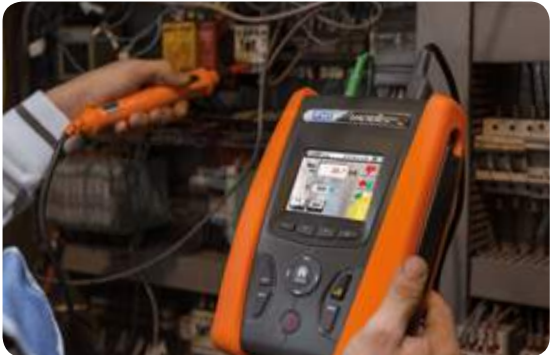
Start/stop misura con puntale remoto PR400.
