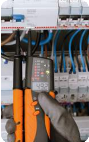
Misura del senso ciclico delle fasi.
