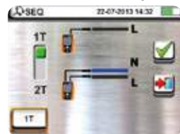
Selezione tipo di misura senso ciclico delle fasi.
