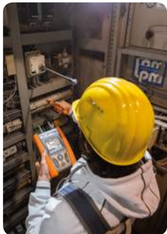
Start/stop misura con puntale remoto PR400.
