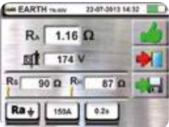
Esito OK misura resistenza di terra.
