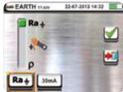
Resistenza di Terra: selezione tipologia di misura.
