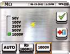
Selezione tensione di prova e valore limite minimo su misura MΩ.
