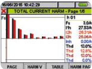
Visualizzazione armoniche di corrente in real time
