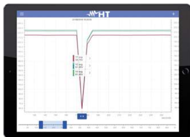
Zoom su un calo di tensione e corrente.
