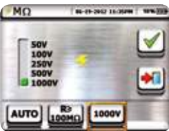
Selezione tensione di prova e valore limite minimo su misura.
