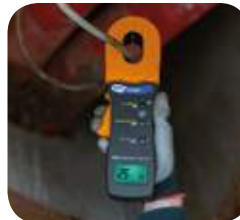
Misura resistenza di terra con pinza T2100.
