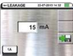
Misura della corrente di dispersione con pinza opzionale HT96U.
