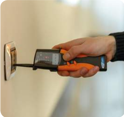
Funzione cercafase tramite pulsante conduttivo.
